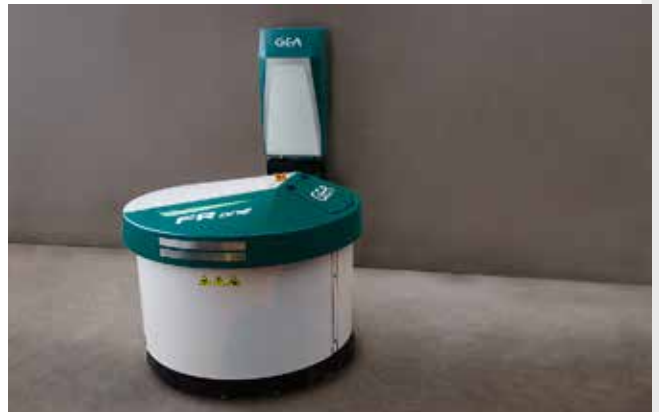
De GEA FRone keert automatisch terug naar het laadstation en kan het station vooruit of achteruit verlaten.
